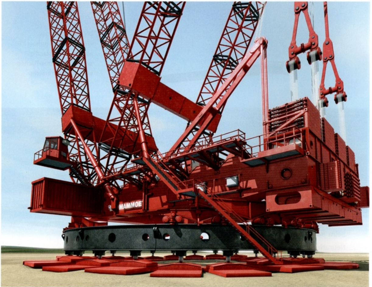
Mit den 200 000 Polygonen und 3 000 Einzelobjekten wollte man dem Zuschauer einen realistischen Eindruck von der gewaltigen, aber kleinteiligen Konstruktion des Krans vermitteln.
