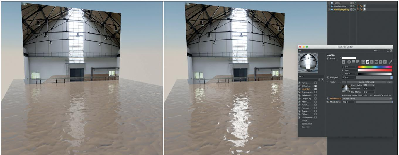
**Bild 26: Das Funktionsprinzip von Quasi-HDR: ein Material mit 200 % starkem Leuchten und einer Textur mit Mischmodus „Multiplizieren“.** Dieses sitzt auf einem Objekt, welches nur für Spiegelung sichtbar ist.
