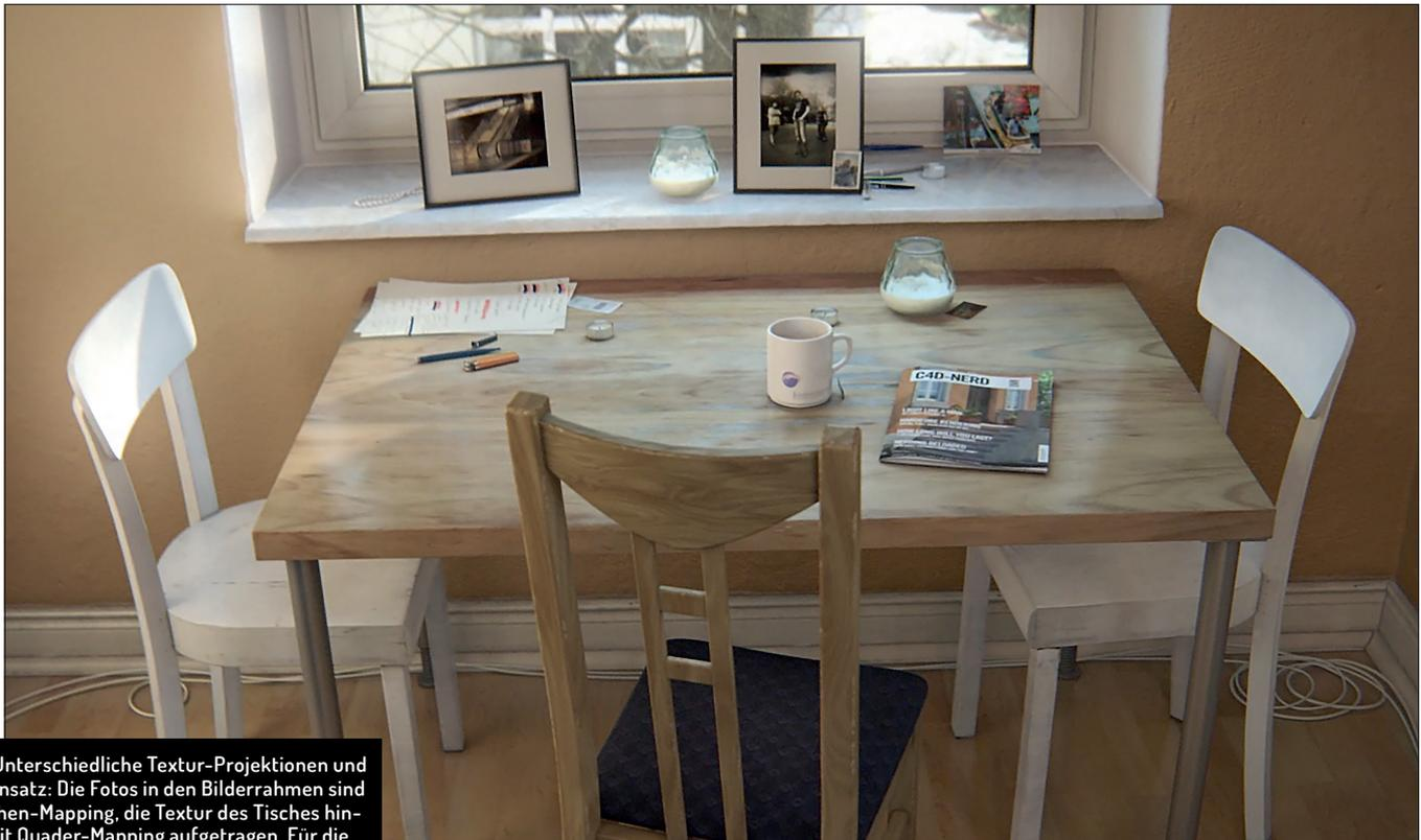
**Bild 10: Unterschiedliche Textur-Projektionen und deren Einsatz:** Die Fotos in den Bilderrahmen sind mit Flächen-Mapping, die Textur des Tisches hingegen mit Quader-Mapping aufgetragen. Für die Textur der weißen Stühle samt ihrer gebogenen Teile wurde UVW-Mapping verwendet.
