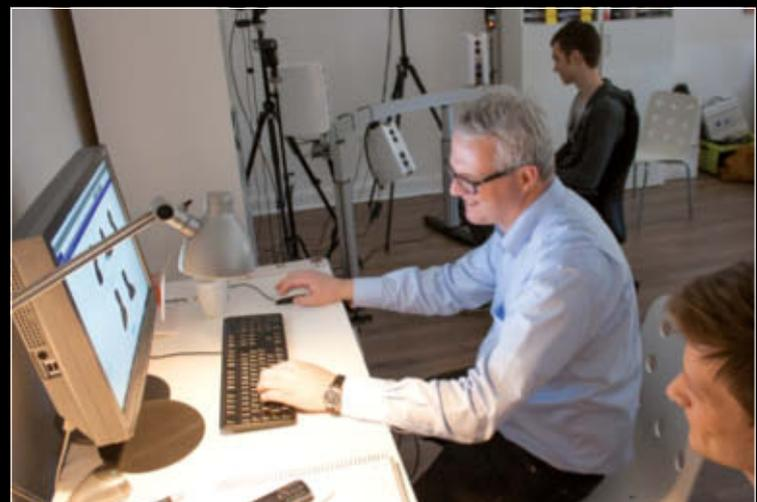
Links: Das Visense-Vario-System von Polymetric samt Blitzaufbau im Studio von Renderbaron. Rechts: On-the-fly-Korrekturen sind direkt in der Scannersoftware möglich. Im Bild: Dr. Peter Neugebauer (Polymetric) beim Steuern des Scan-Vorgangs.
